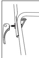
**Cortacésped con palancas de desenganche rápido.**
